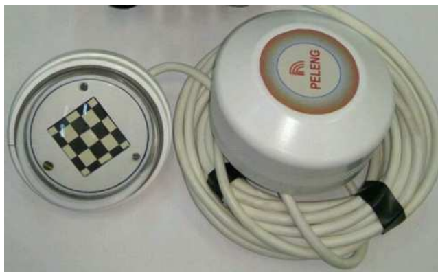
Рисунок 2 – Общий вид пиранометра «Пеленг СФ-06»
