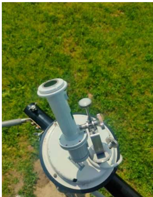
Рисунок 10 – Измерение прямой радиации
