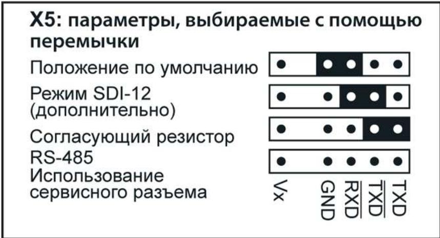
Рис. 3 Настройки сервисных разъемов и переключки X5
