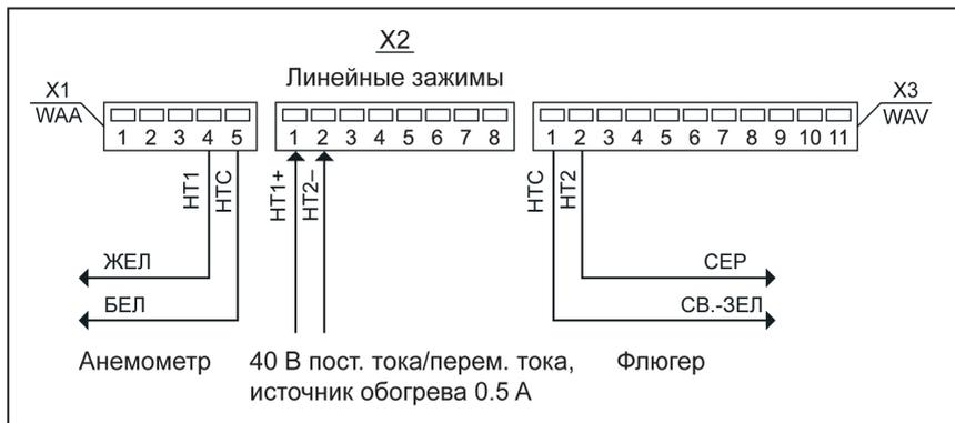
Рис. 9 Подключение питания обогрева с источником питания 40 В
