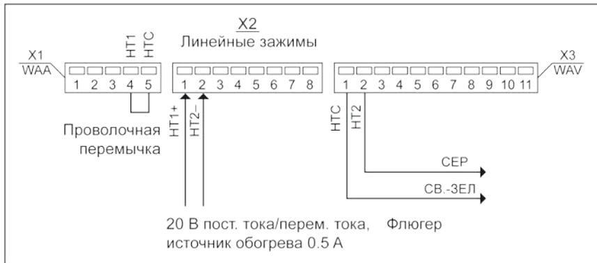
Рис. 12 Подключение источника питания обогрева только для флюгера
