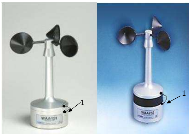
Рисунок 2. Схема пломбирования преобразователей WAA151/252. Пломбы – 1.
