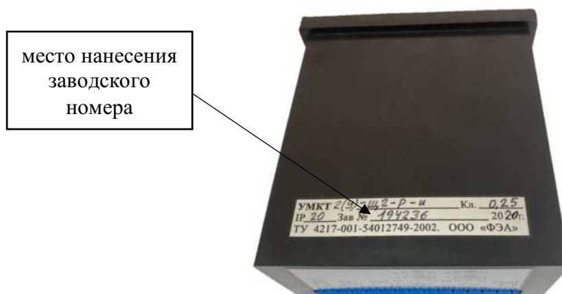
Рисунок 5 – пример маркировки прибора модели УМКТ (У)
