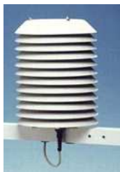
Рис. 3.7. Экран радиационной защиты DTR13
