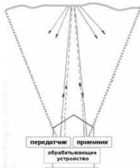
Рис. 5.2. Схема лазерного измерителя ВНГО
