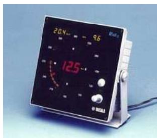
Рис. 4.4. Многоканальный дисплей измерителя Wind 30
