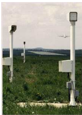
Рис. 6.16. Измеритель дальности видимости MITRAS
