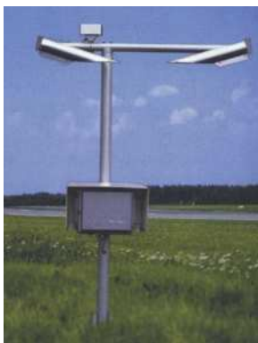
Рис. 6.17. Измеритель видимости FD12
