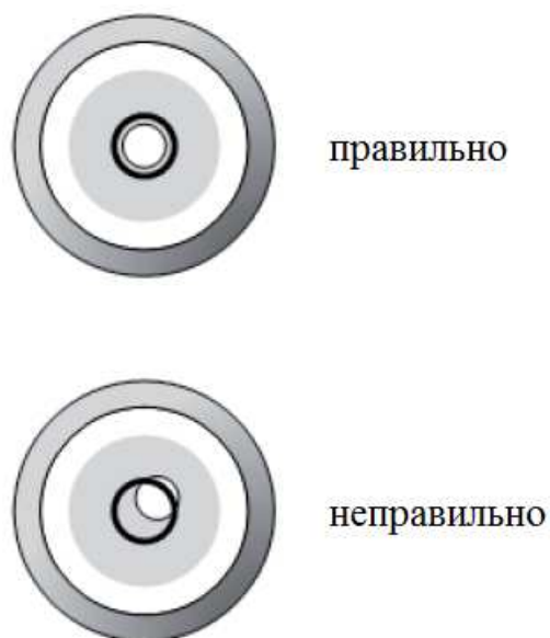
Рисунок 2 — Контроль наклона основания с помощью пузырькового уровня
