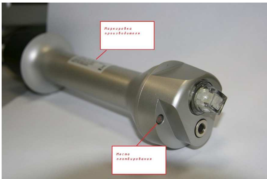
Рисунок 2 – Пиргелиометр СНР 1. Место нанесения маркировки и пломбирования
