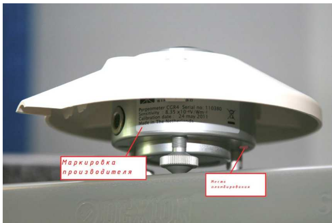
Рисунок 2 – Пиргеометр CGR 4. Место нанесения маркировки и пломбирования
