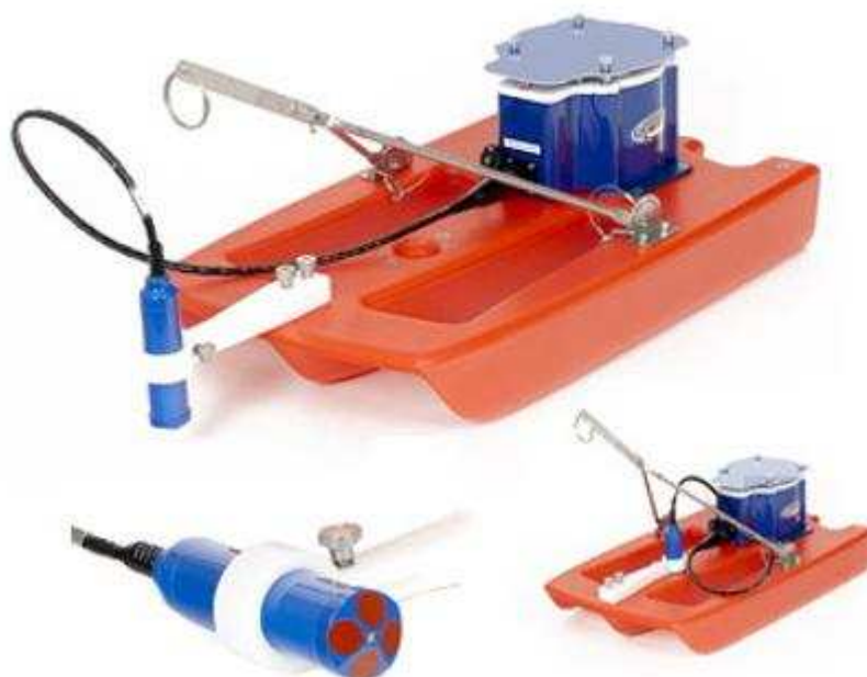
Рисунок 1. Общий вид профилографов акустических доплеровских.
