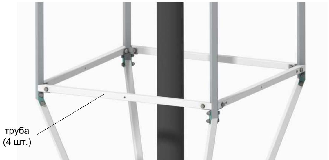
**Рисунок 2.7 – Установка трубы (из комплекта ветрозащиты)**
