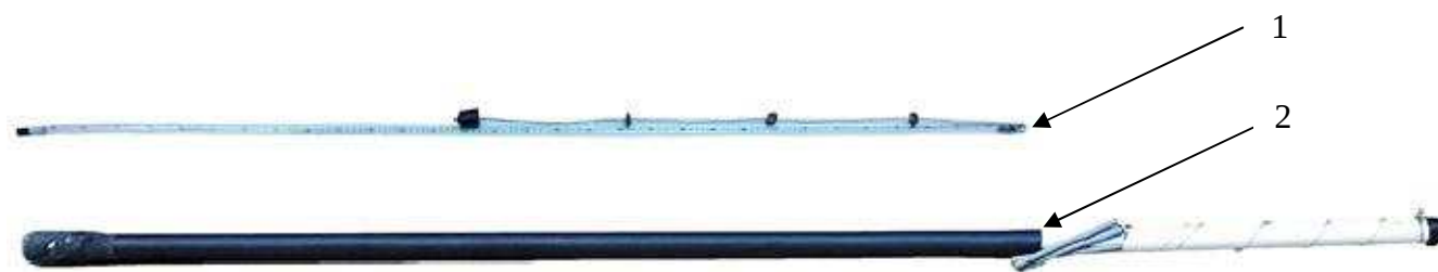
Рисунок 1 – Общий вид мерзлотомеров АМ-21 1 – защитная трубка, 2 – трубка ПВХ с измерительной шкалой
