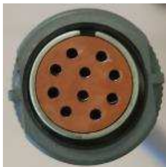
Рисунок 2.2– Розетка PC10TB кабеля №1
