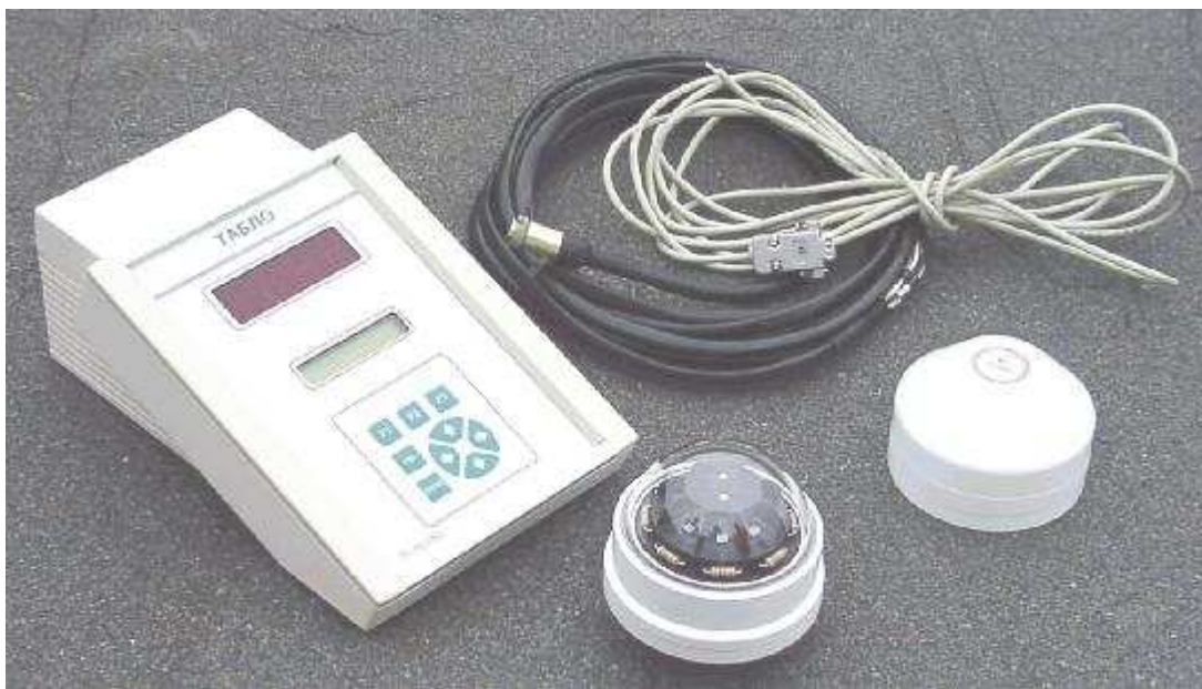
Рисунок 1 - Приборы для определения продолжительности солнечного сияния ПЕЛЕНГ ВК-05 - общий вид
