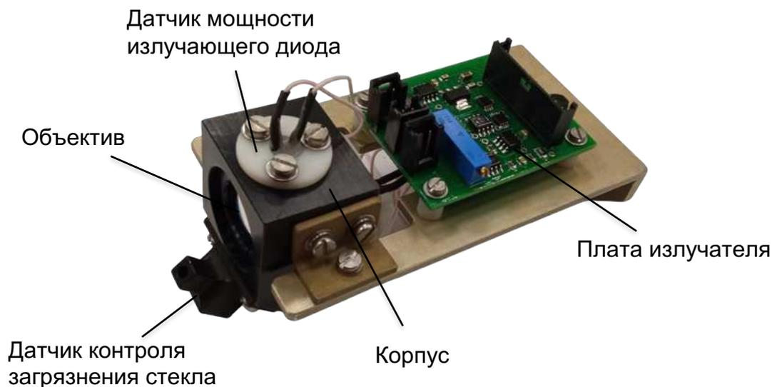
**Рисунок 1.4 – Излучатель вне корпуса**
