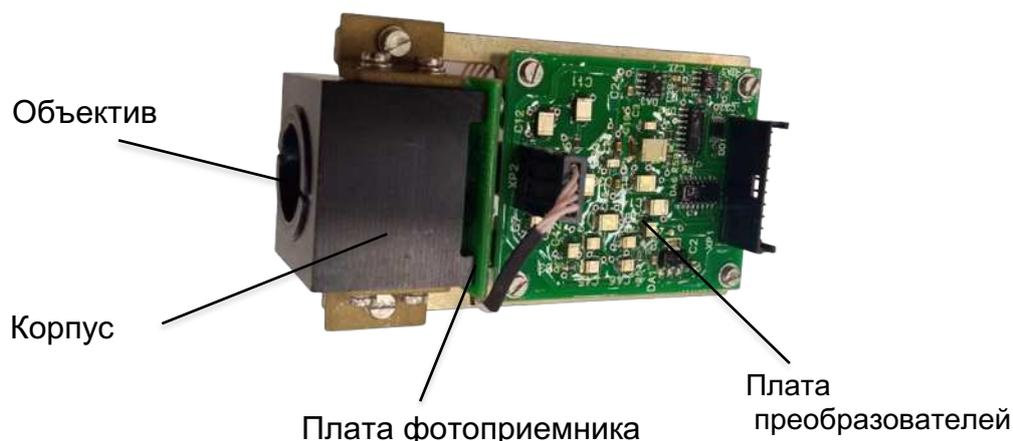
**Рисунок 1.5 – Приёмник вне корпуса**
