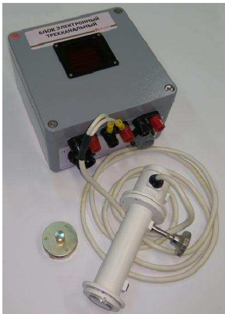
Рисунок 1 – Общий вид актинометров «Пеленг СФ-12»
