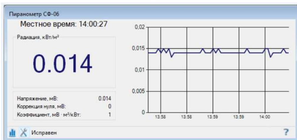
Рисунок 39 – Окно отображения энергетической освещенности измеренной пиранометром ПЕЛЕНГ СФ-06-21, кВт/м<sup>2</sup>
