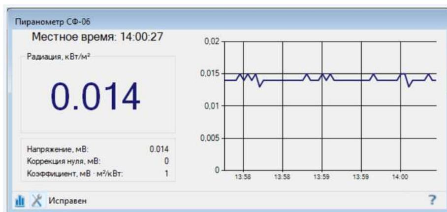
Рисунок 34 – Окно отображения энергетической освещенности измеренной пиранометром ПЕЛЕНГ СФ-06-21, кВт/м<sup>2</sup>
