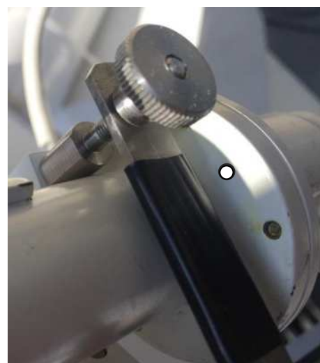
Рисунок 22 а) световое пятно отверстия актинометра вне зоны черной метки; б) проекция отверстия в зоне черной метки
