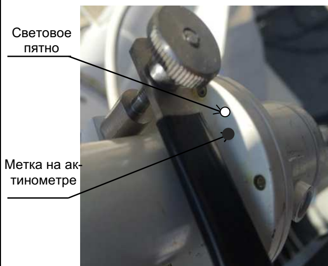
Рисунок 22 а) световое пятно отверстия актинометра вне зоны черной метки; б) проекция отверстия в зоне черной метки
