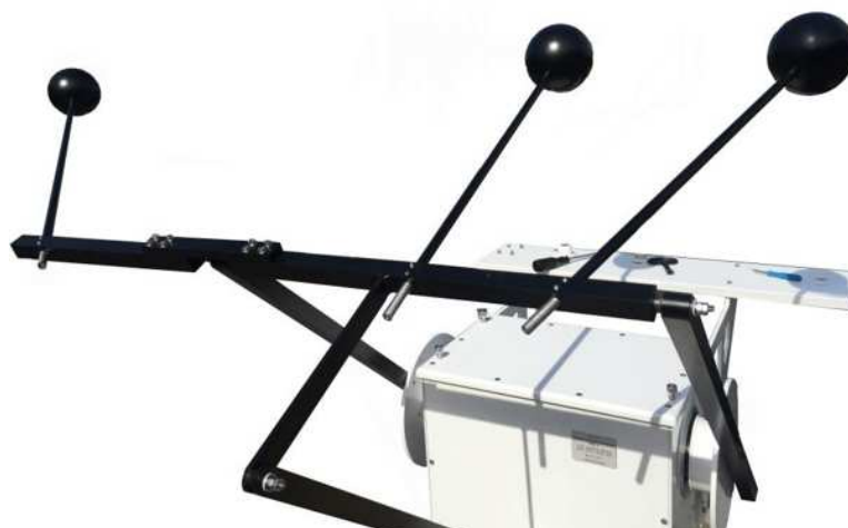
Рисунок 16 – Т-образная штанга с затенителями
