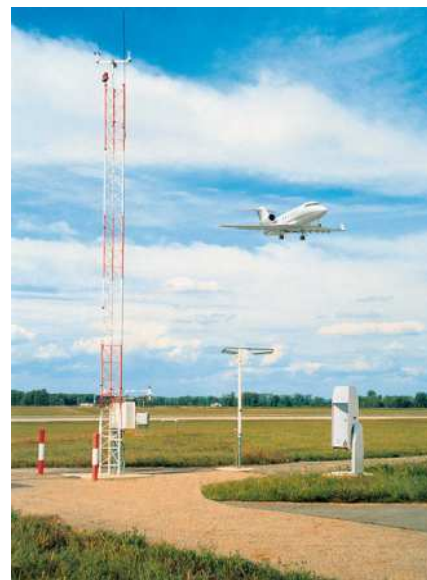
PWD22 рекомендован для автоматических систем метеорологических наблюдений (AWOS).
