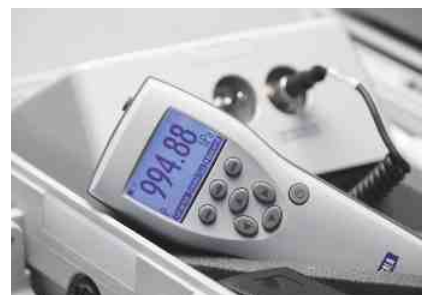
Ручной индикатор MI70, показывающий преобладающее давление в гПа
