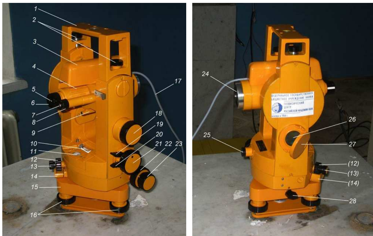
Рис. 1. Феррозондовый деklinометр/инклинометр на основе немагнитного теодолита Carl Zeiss Theo 010B.
