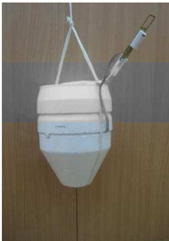
Рисунок 1 – Фотография общего вида радиозонда
