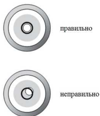
Рисунок 2. Контроль наклона основания с помощью пузырькового уровня.
