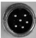
— скорость и направление ветра соединяется с разъемом XP1;
