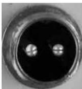
— напряжение 12 вольт соединяется с разъемом XPS. Для удобства подключения внешнего кабеля питания и связи может быть установлен 4-контактный разъем, на который дополнительно выведены цепи Rx<sub>0</sub> или Data- (контакт 4) и Tx<sub>0</sub> или Data+ (контакт 3) Com0).
