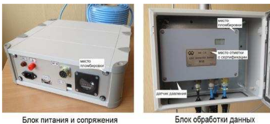
Рис. 2 Схема пломбирования комплексов МК-18
