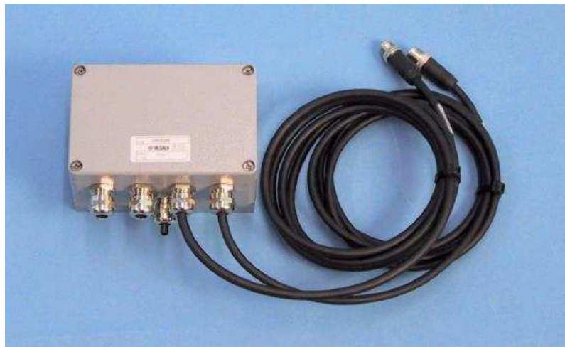
Рисунок 71 Соединительная коробка для датчика CNR1
