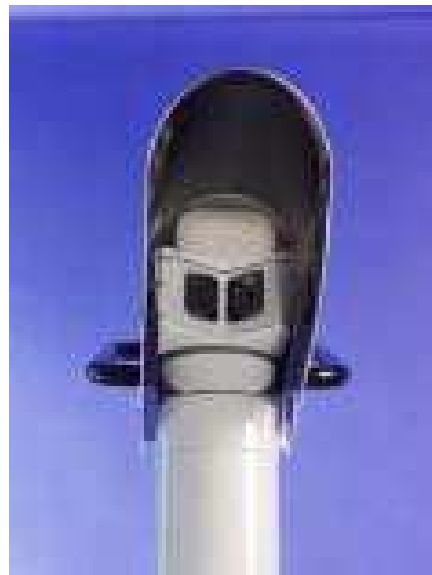
Измерения видимости производятся через V-образное окно с поправкой на загрязненность
