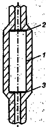
Рис. 12.1. Кондуктометрическая ячейка датчика электропроводности.
