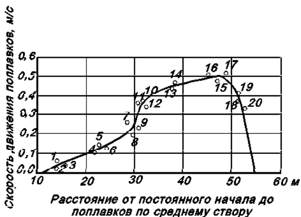
Рис. 8. Эпюра распределения скорости движения поплавков по ширине реки
