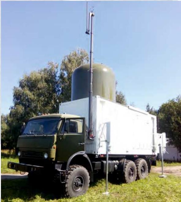
Малогабаритный метеорологический комплекс «КММ-1» предназначен для измерения параметров атмосферы при помощи аэрологического зондирования до высот 40 км и автоматизированной метеорологической станции, а также наблюдения за явлениями погоды (в т.ч. опасными – гроза, град, шквал) в радиусе до
