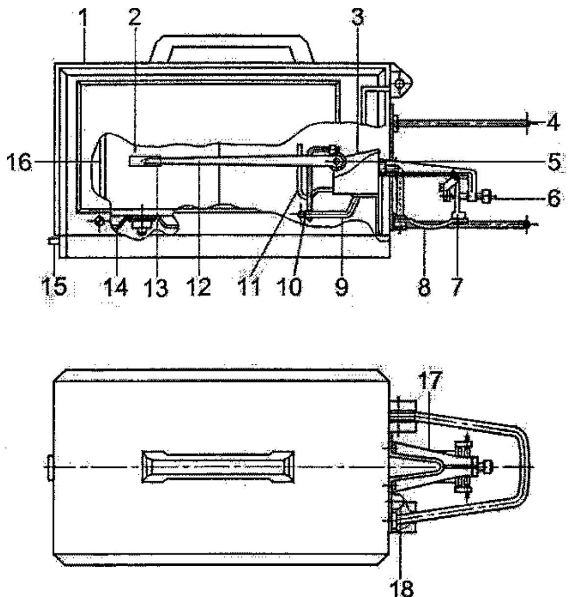
1 – корпус; 2 – барабан с часовым механизмом; 3 – кронштейн;
