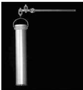
Рис. 23. Снегомер весовой BC-4 (общий вид)
