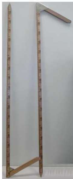
Рис. 24. Рейка ледоснегомерная ГР-31
