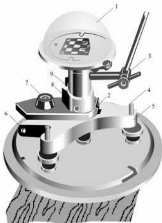
Рис. 4. Пиранометр универсальный термоэлектрический М-80М:
