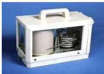
Рис. 35. Барограф метеорологический М-22А (общий вид)
