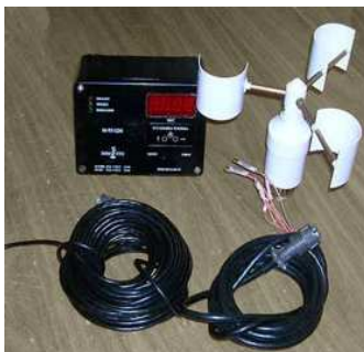
Рис. 42. Анемометр сигнальный цифровой М-95-ЦМ
