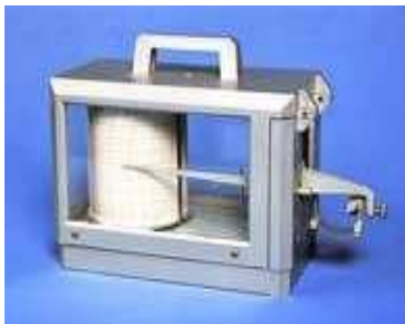
Рис. 6. Термограф метеорологический М-16А (общий вид)
