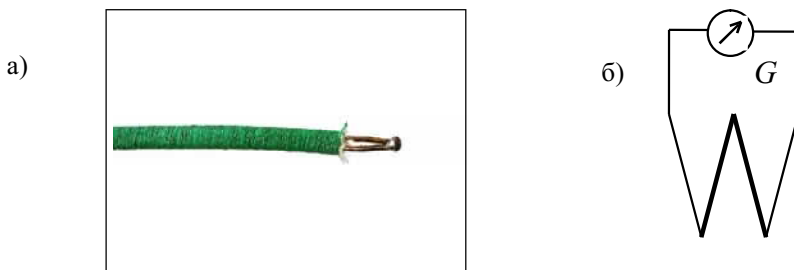
Рис. 1.20. Термопара а) спай термопары; б) схема
