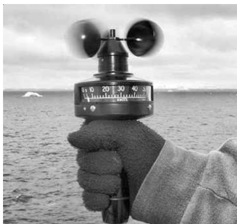
Рис. 3.7. Индукционный анемометр АРИ-49
