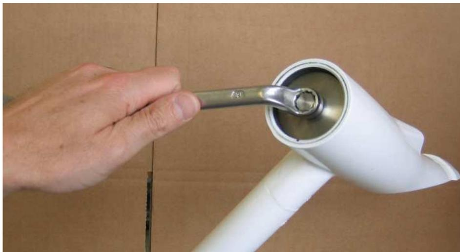
**Рис. 47. Снятие стопорного кольца модуля (показано для передатчика)**
