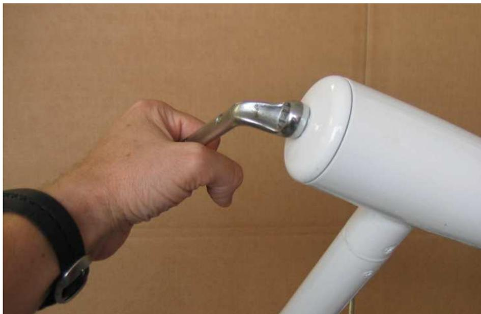
**Рис. 46. Снятие концевой заглушки (показано для передатчика)**
