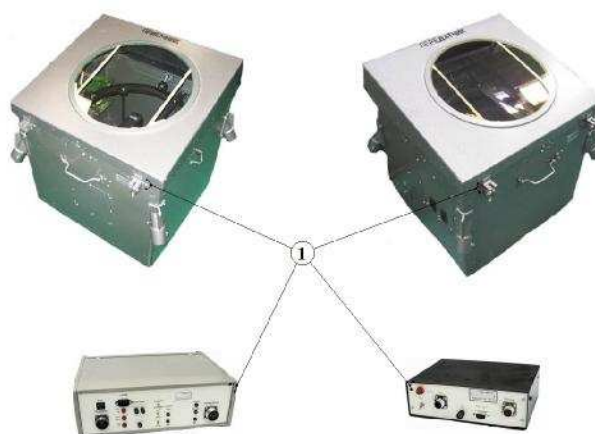
Рис. 1 Датчики высоты облаков ДВО-2 1 – приемник, 2 – излучатель, 3 – блок измерительный , 4 – пульт дистанционный
