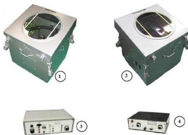
Рис. 1 Датчики высоты облаков ДВО-2 1 – приемник, 2 – излучатель, 3 – блок измерительный , 4 – пульт дистанционный
