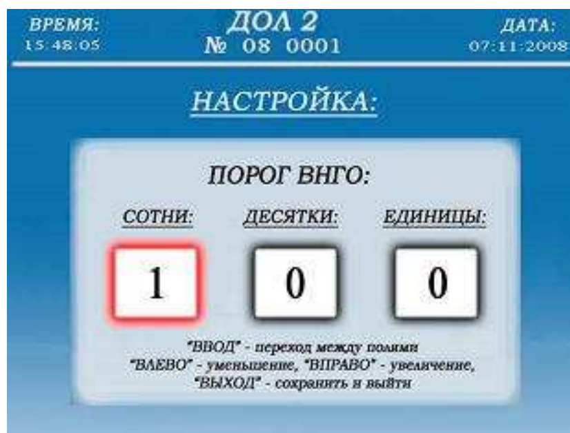
Рисунок 2.12 Режим установки порогового значения ВНГО
