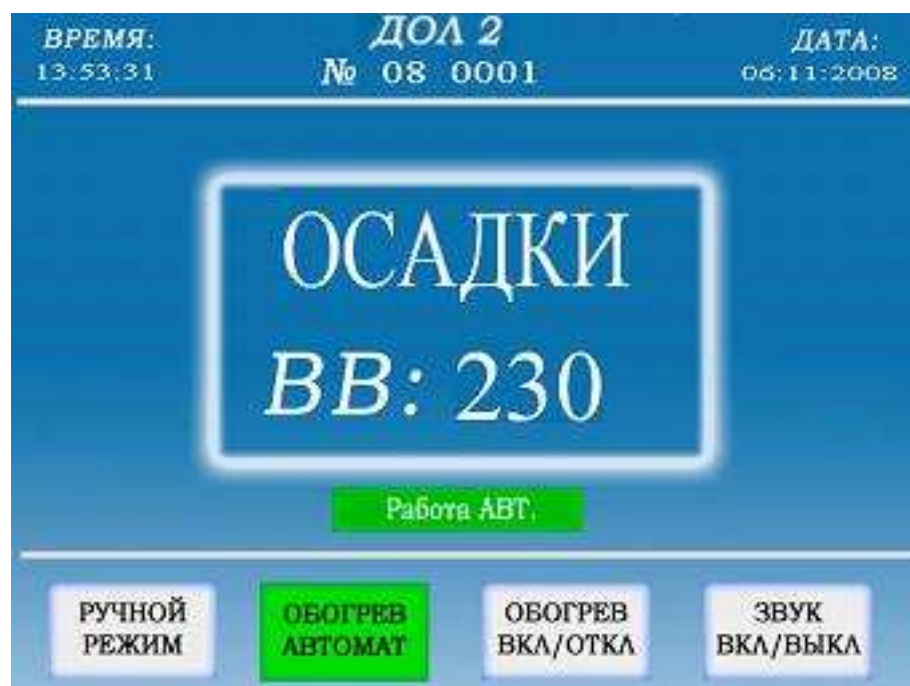
Рисунок 2.4 Индикация вертикальной видимости
