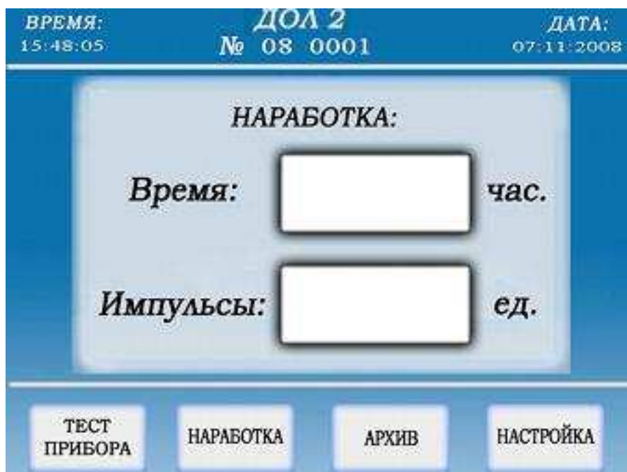
Рисунок 2.8 – Вид дисплея БУ в режиме индикации наработки.
