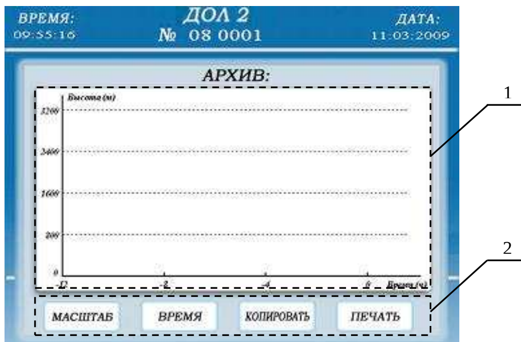
Рисунок 2.9 – Вид дисплея БУ в режиме работы с архивом
