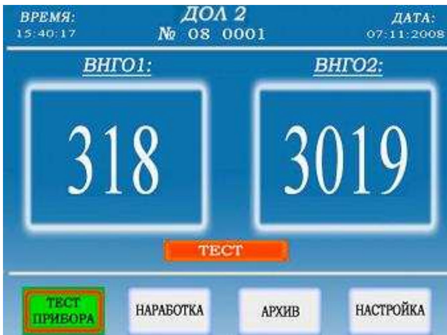
Рисунок 2.7 – Индикация, аналогичная отображаемой на дисплее БУ в режиме “ТЕСТ”.
