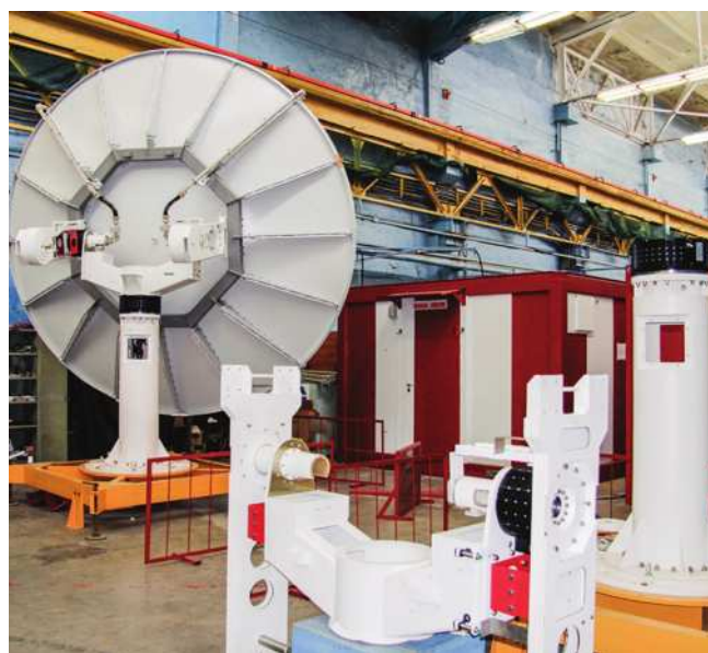
Антенная система «ДМРЛ-10» с безредукторными синхронными двигателями
