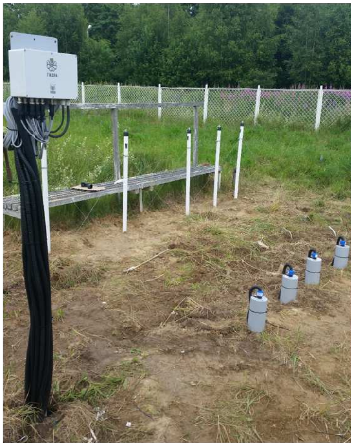
Рисунок 4 – Размещение датчиков температуры почвы на глубинах
