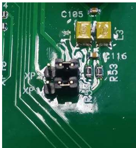
Рисунок 1.4 – Дамперы на плате управления для интерфейса V23.
