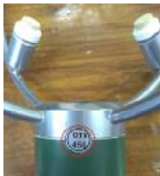
а) корпус акустического термоанемометра ДСВ-16 (датчика метеорологических параметров ДСВ-15)
