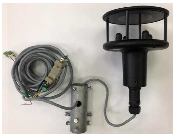
Датчик скорости и направления ветра WindSonic
