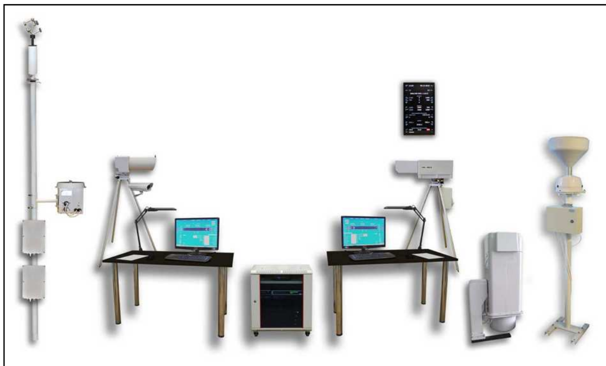
Рисунок 1. Общий вид АМС «ЛОМО-МЕТЕО-01»
