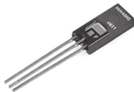
Рис. 3.35. Измеритель относительной влажности ННН-4000 фирмы Honeywell
