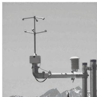
Рис. 1.10. Трехмерный анемометр «*Sonic-3 Scientific*» компании ООО НПО «Гидротехпроект»
