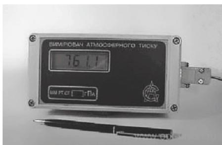
Рис. 2.13. Цифровой измеритель атмосферного давления БАР
