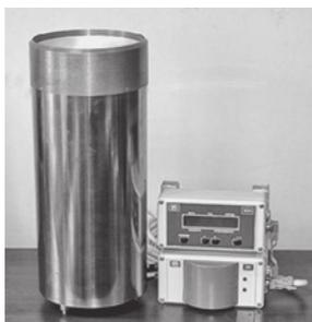
Рис. 2.15. Измеритель количества осадков ВОА-1
