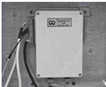
Рис. 1.33. Блок центральный измерительный (БЦИ)
