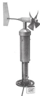
Рис. 2.3. Измеритель параметров ветра ИПВ-01
