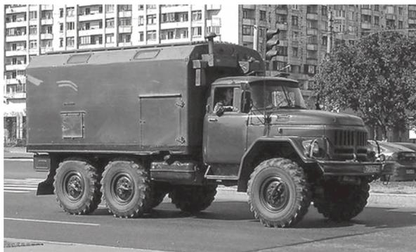
Рис. 5.2. Автомобиль ЗИЛ-131 с кузовом КМ-131
