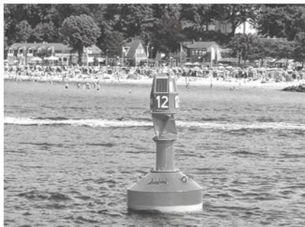
Рис. 4.10. Буйковая автоматическая метеорологическая станция
