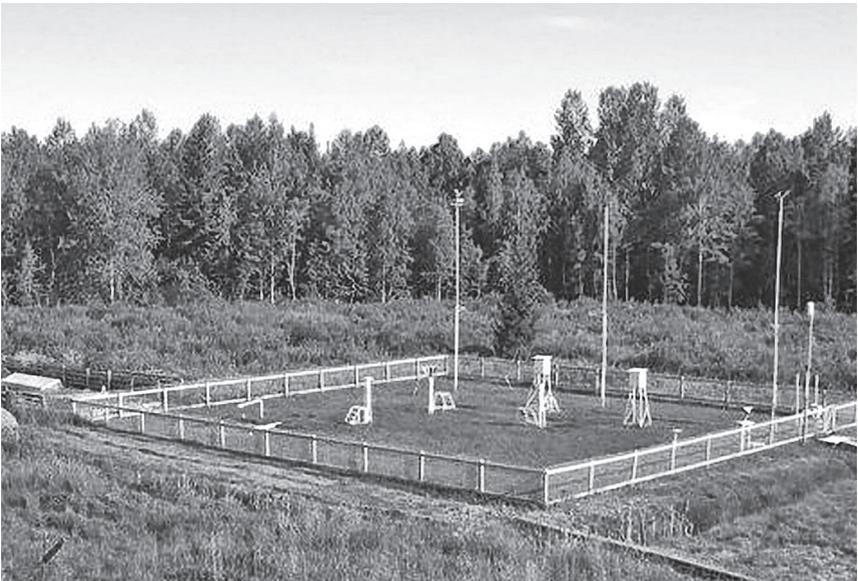
Рис. 1.1. Наземная метеорологическая станция общего назначения
