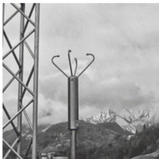
Рис. 1.9. Двумерный анемометр «*Sonic-2 Wind*», компания НПО «Гидротехпроект» для измерения 2-х комп. ветра и акуст. температуры
