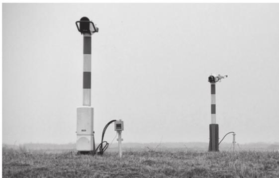
Рис. 2.6. Измеритель метеорологической оптической дальности видимости *LT31*
