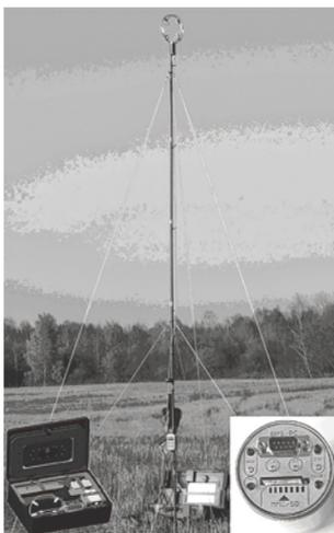
Рис. 1.14. Экспедиционный вариант ультразвуковой метеостанции «Эксметео-01» для сопровождения полевых исследований
