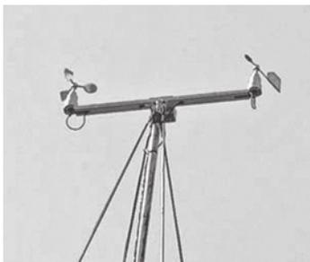
Рис. 2.12. Анеморумбометр МАРК 60.1
