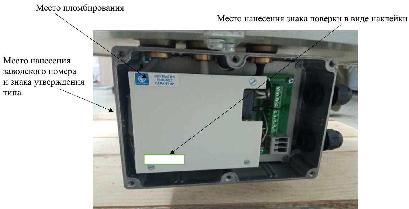
Рисунок 2 – Место пломбирования осадкомеров весовых ОВ-01; Места нанесения знака поверки, заводского номера, знака утверждения типа осадкомеров весовых ОВ-01
