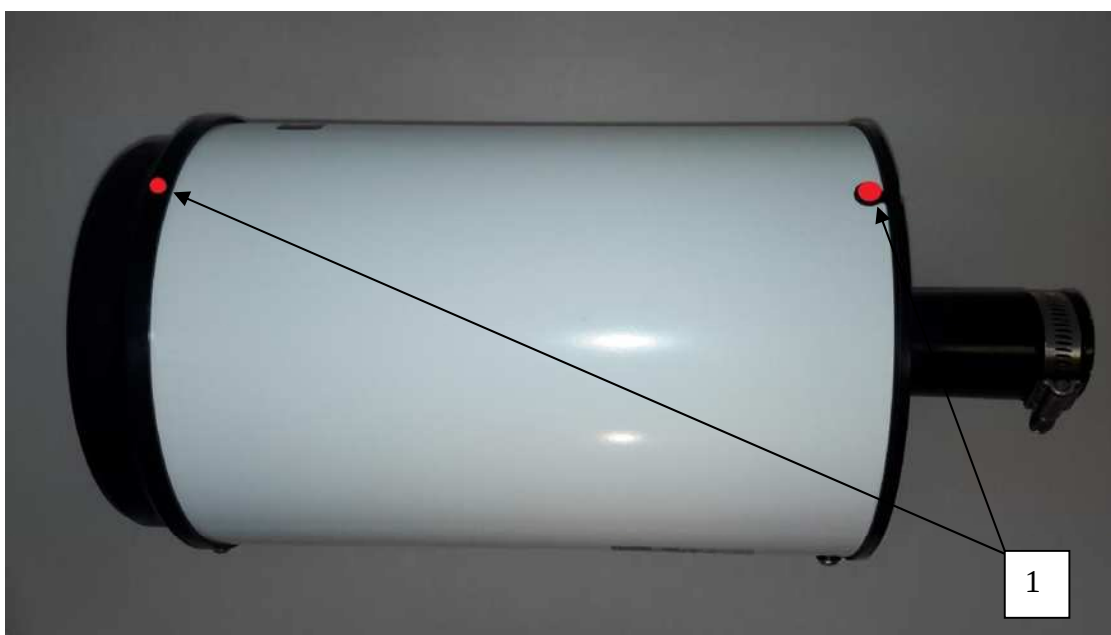
Рисунок 2 - Схема пломбирования осадкомеров МПДО-500 1 - пломбы на корпусе.
