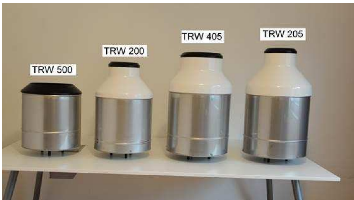
Рисунок 1 – Датчики количества осадков весовые TRW
