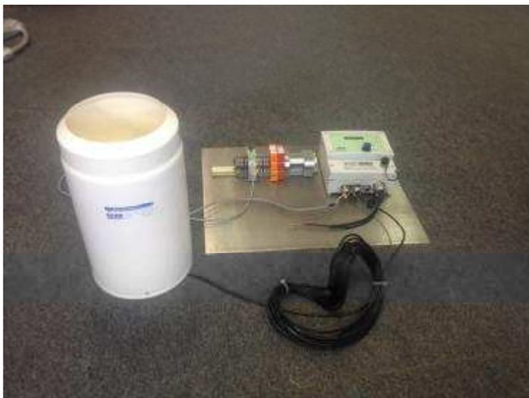
Рис.1 Общий вид комплексов автоматизированных измерительных жидких осадков RG-50
