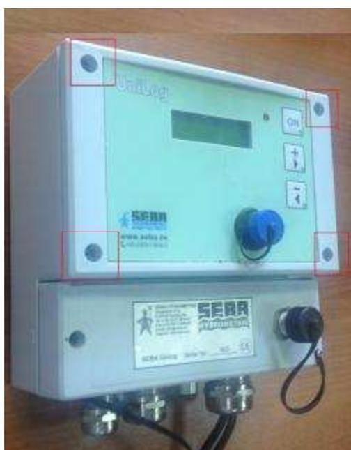
Рис.2 Контроллер SEBA MDS-5-Unilog с указанием мест пломбирования
