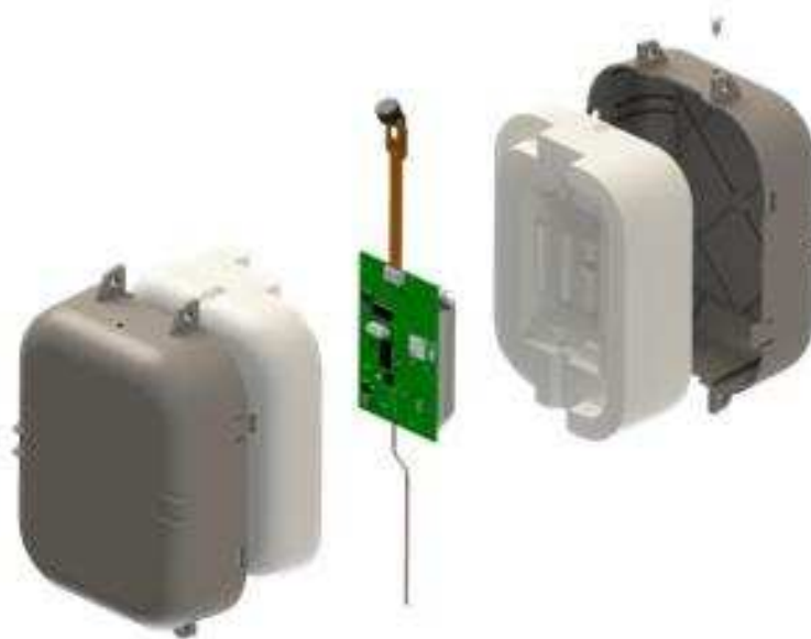
Рисунок 1 – Общий вид радиозондов метеорологических МЗЭ-1
