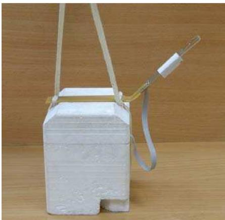
Рисунок 1 - Фотография общего вида радиозонда
