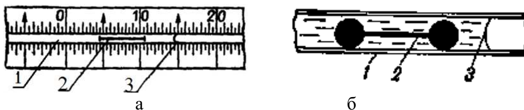
Рисунок 4.3 Устройство минимального термометра
